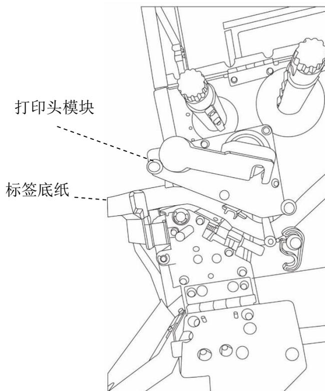
6. 将剥纸器释放栓往下压，并将纸张穿过剥纸器模块下方。
