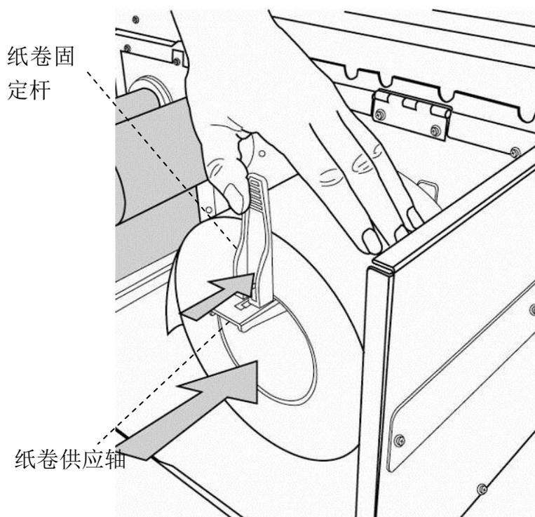
3. 逆时针转动门挡扣，打开铁片支架并逆时针打开纸张固定器。
