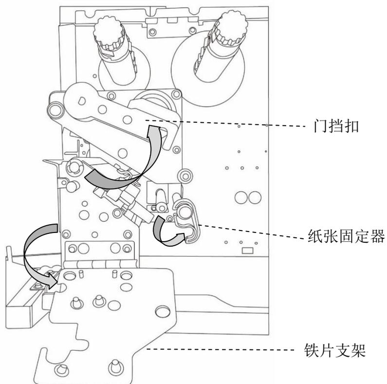
4. 将纸张穿过打印头模块下方，并穿过纸张传感器，将纸张放置于滚轴上方。
