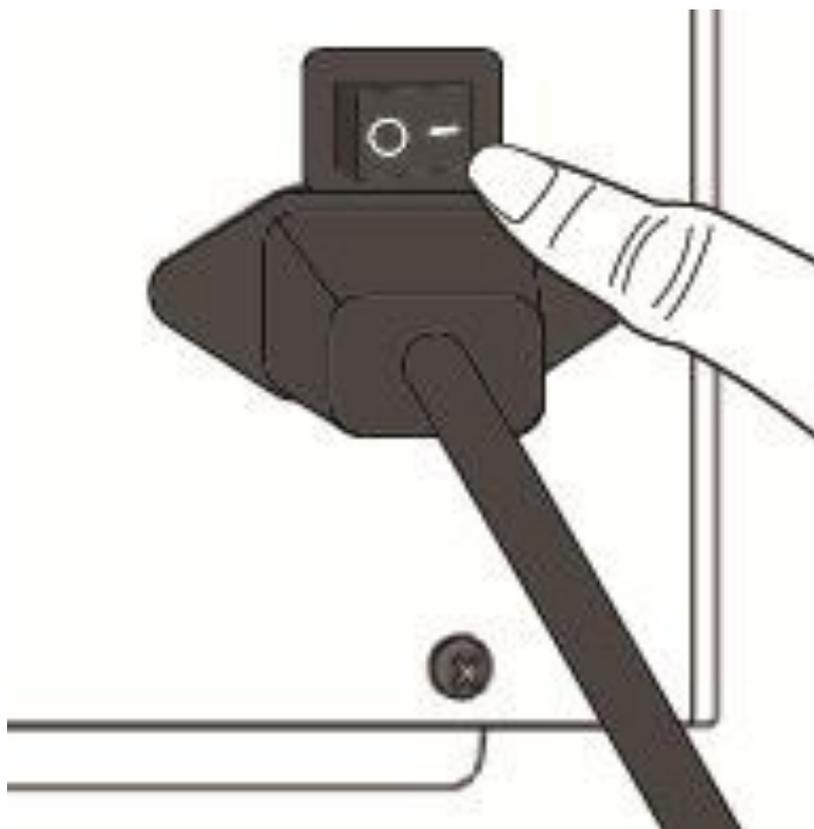
2. 确认、纸张和碳带指示灯会一齐亮，确认灯关闭期间 LCD 会显示固件版本，之后 LCD 显示准备打印，三个灯号都会恒亮，开机完成。
