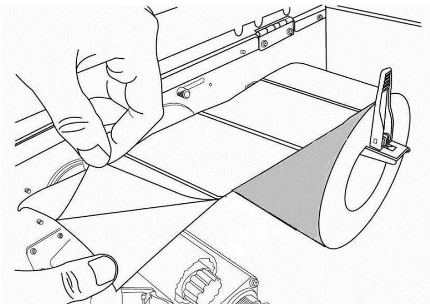
5. 将卷标底纸穿过打印头模块下方。
