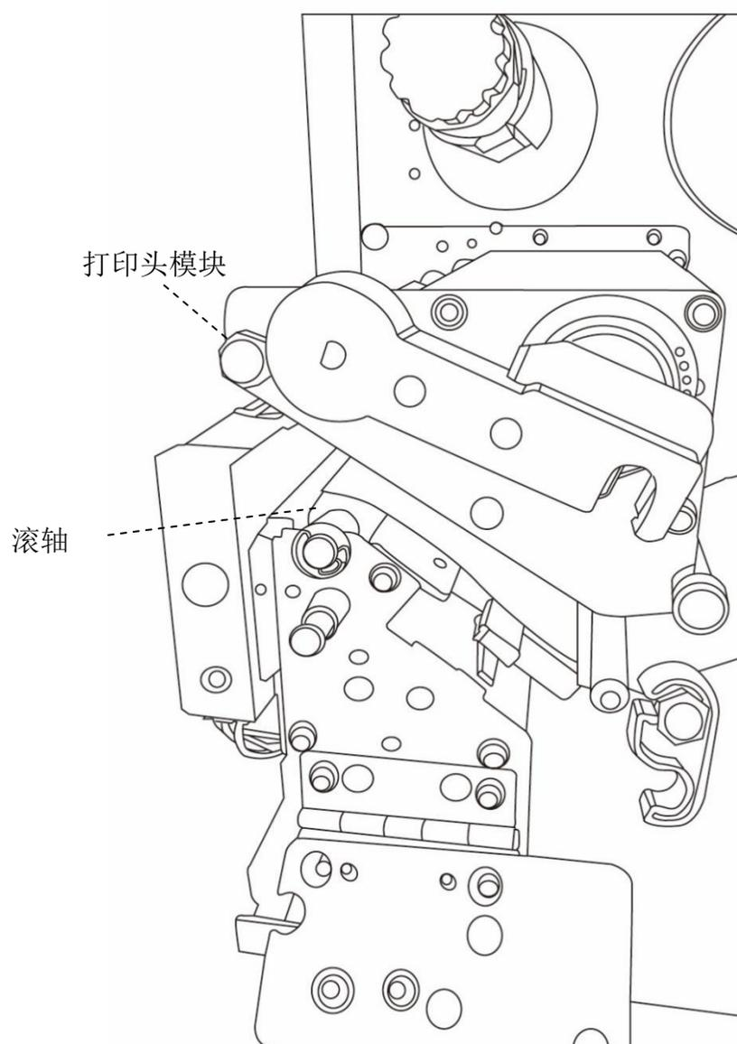
5. 将纸张固定器恢复原位，关上铁片支架，然后卡入门挡扣。
