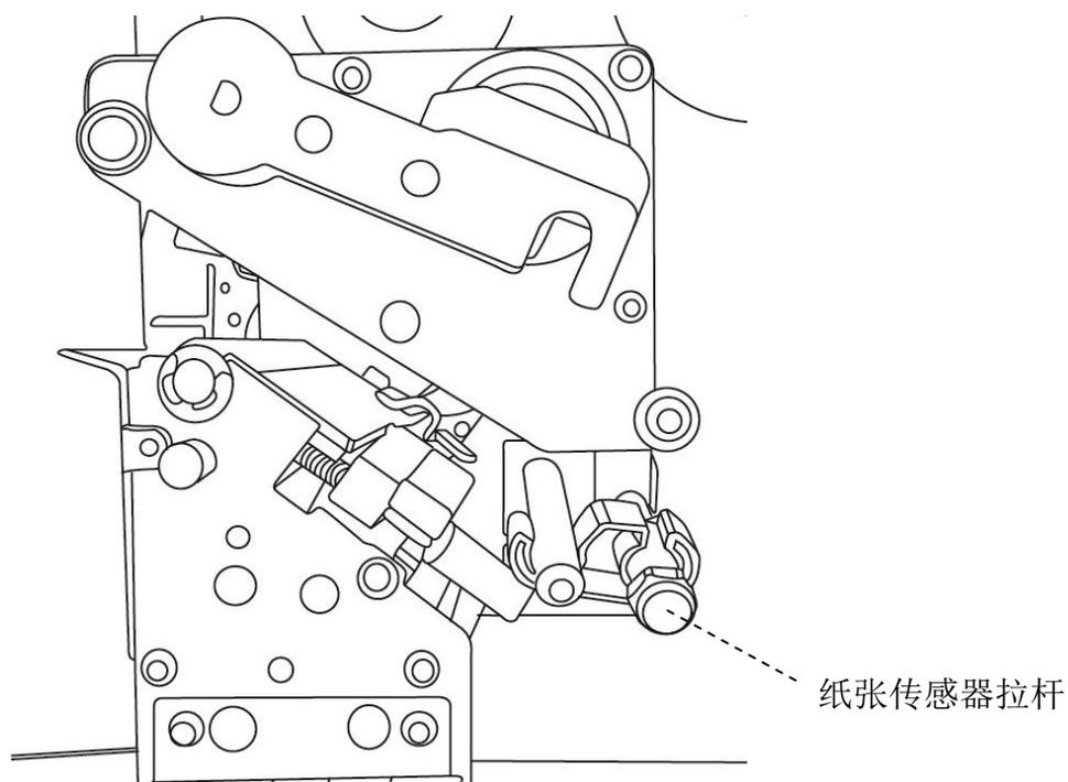
务必确认纸张传感器位置标示(Media sensor position mark)座落在标签纸孔洞的正上方。
