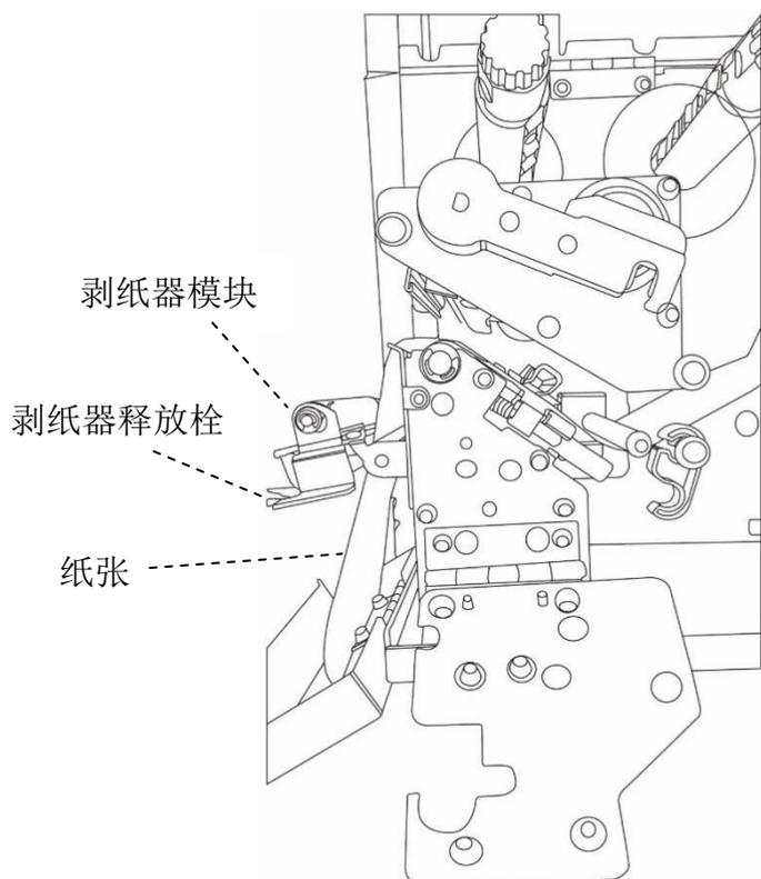
7. 关回纸张固定器并推至纸张边缘固定纸张，盖回铁片支架，然后卡入门挡扣使用剥纸器释放栓关上剥纸器模块。
