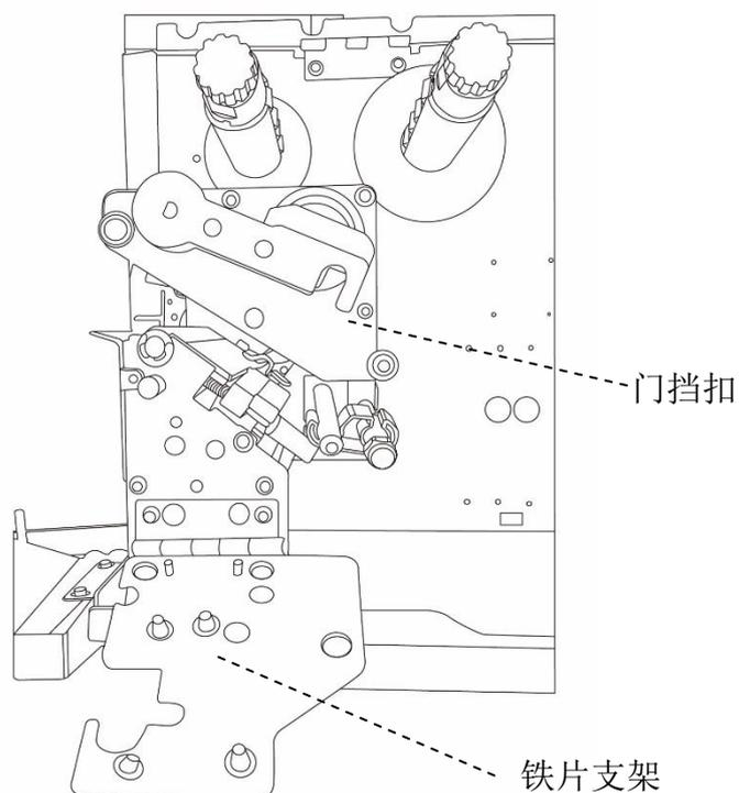
将纸张传感器拉杆往下拉，即可向左或向右调整纸张传感器模块位置。
