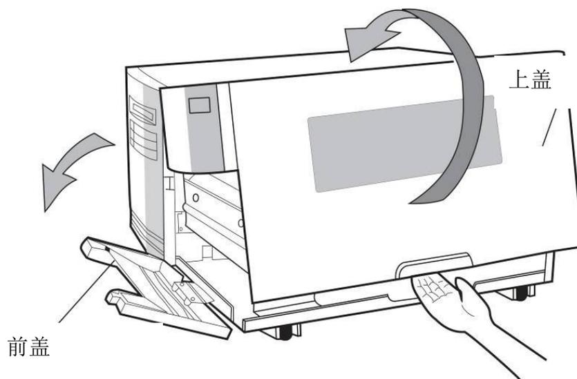
2. 逆时针转动门挡扣，打开铁片支架。
