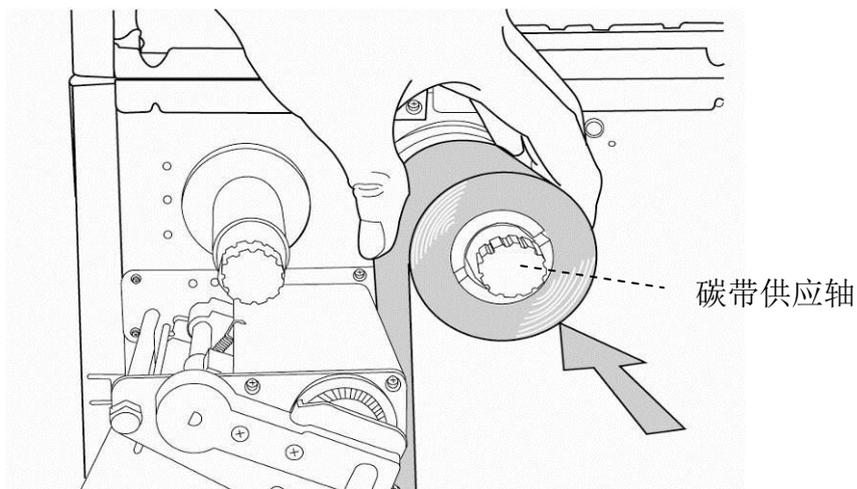
4. 将碳带绕过打印头模块下方。将碳带前缘贴到碳带卷筒，并将部分碳带卷到卷筒上。确定将碳带的碳粉层朝下。
