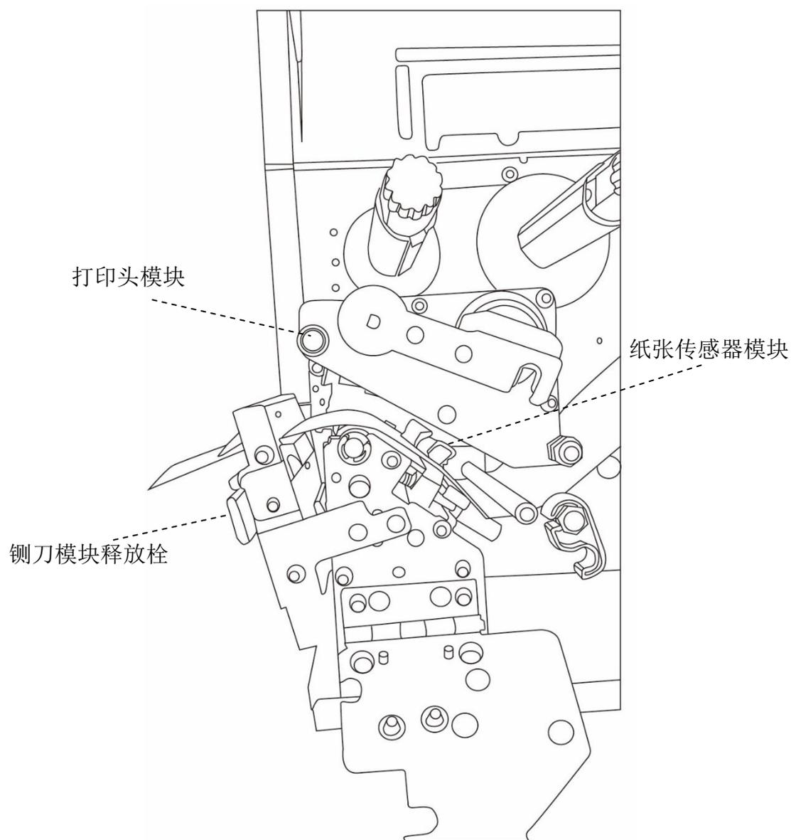
5. 推回裁刀模块，将纸张固定器恢复原位，关上铁片支架，然后卡入门挡扣。
